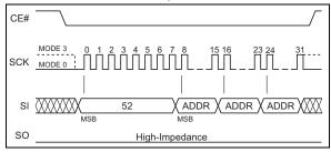
FIGURE 5-10: 64-KBYTE BLOCK ERASE SEQUENCE
